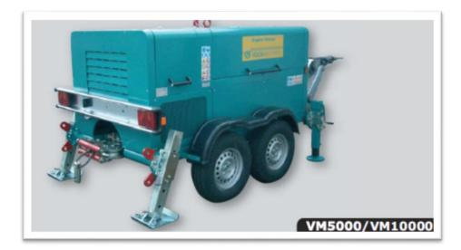
Azionato idraulicamente da un motore diesel. Montato su una base carrellata. Indicatore dinamometrico che consente la disinserzione automatica del tiro appena si raggiunge la forza di tiro desiderata. Freno negativo incorporato. Dotato di occhione centrale per il carico e scarico da automezzo.
